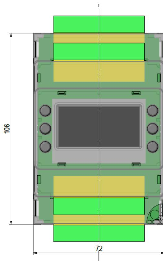
Контроллер M204 выполнен в корпусе 4DIN на рельс 35мм.
